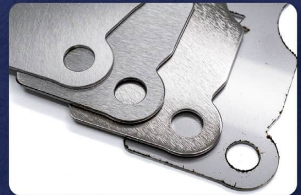
Entgraten und Endoberfläche - Edelstahl
