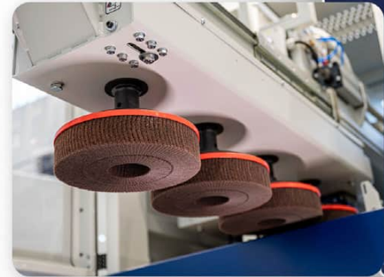
Tellerbürsteneinheit mit Scheiben Durchmesser Discmatic 260
